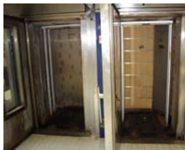
Stikkenöfen Luxrotor ohne und Ecostone mit Thermosteinen.
