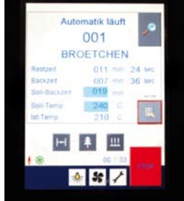
Nach ca. 7,5 Minuten fällt der Ofen auf die Tiefsttemperatur von 210 °C.
