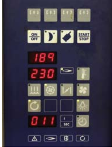
Der Ofen fällt nach sieben Minuten auf die Tiefsttemperatur von 189 °C.
